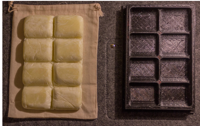
Figure 5: Premier prototype du moule de Natsukola en PLA. Dimensions: 170x110x15.
